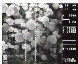
Figura 3. Microfotografía al SEM. MP cargadas con bds. Condiciones: B=10%, T=180°C, A=100%.
